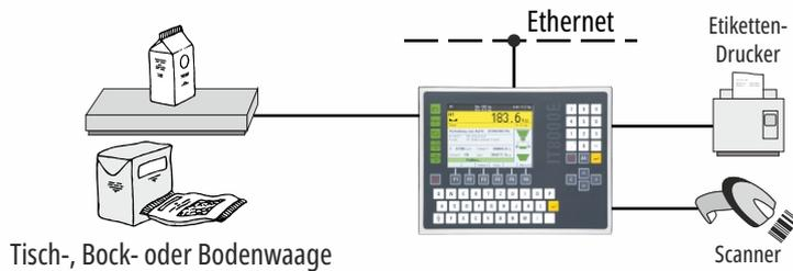
**Stichproben-Kontrollwaage gemäß der Fertigpackungs-Verordnung**
